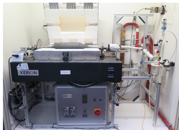
Die „pool-in-loop“-Versuchsanlage: Ein Drehrohrreaktor.
