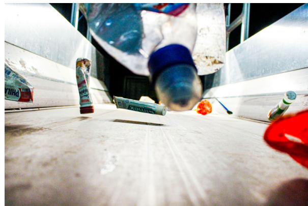
Mittels Sensoren werden Kunststoffverpackungen erfasst.
